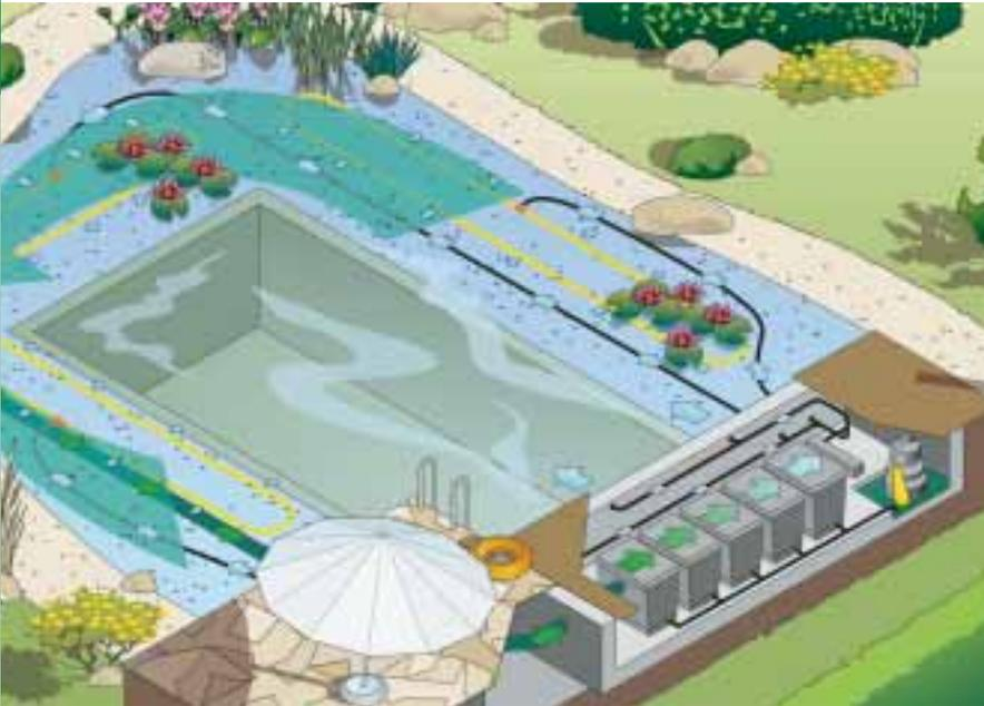
Estructura esquemática: Los filtros modulares ProfiClear son excelente aptos para el uso en estanques de natación
